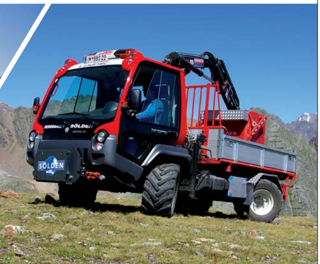
UNITRAC 102 // Kippbare Komfortkabine, Einzelradfederung, 4-Rad-Lenkung, 5000 kg Nutzlast, Partikelfilter, 16/16-Gang-Splittgetriebe, 2-Kreis-Hydraulik
