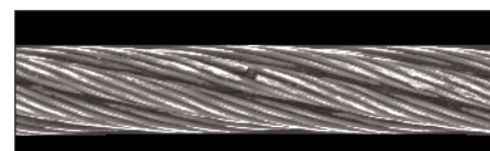
Automatisches Finden von Fehlern: Drahtbruch
