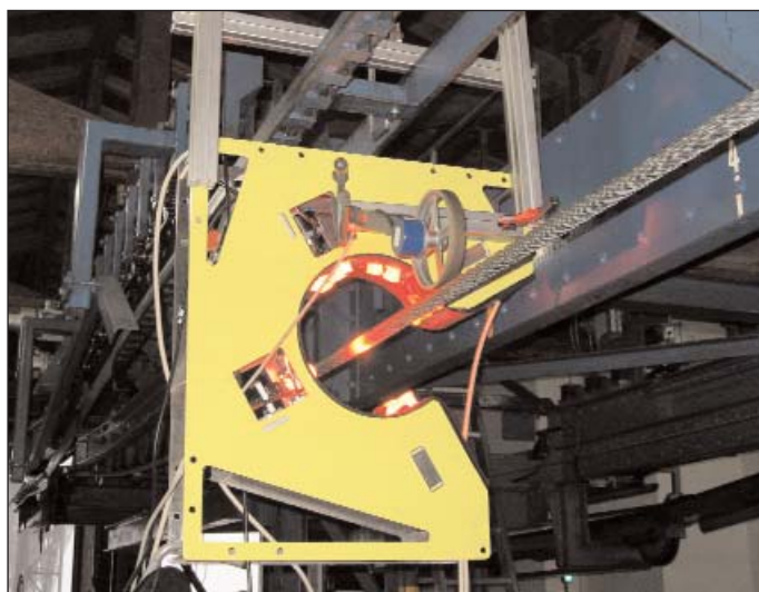
Mit vier Kameras wird das vorbeilaufende Seil aus allen Blickwinkeln aufgenommen. Der Seil-Umfang ist in vier Bereiche unterteilt, die mit je einer CCD-Zeilenkamera erfasst werden. Durch vier sich überschneidenden Blickwinkel ist eine sichere Beurteilung aller sichtbaren Außendrähte gegeben.
