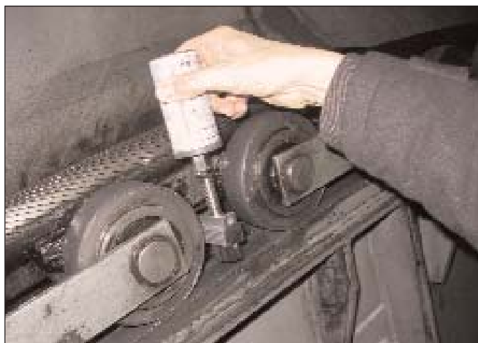
Food Grease LT2-Schmier-spender mit Pinsel - diese Variante wurde in Zermatt noch nicht getestet, bietet sich aber gerade für Rollenketten an, erspart sie doch durch die Pinselvorrichtung das händische Nachpinseln zwischen den Rollen
