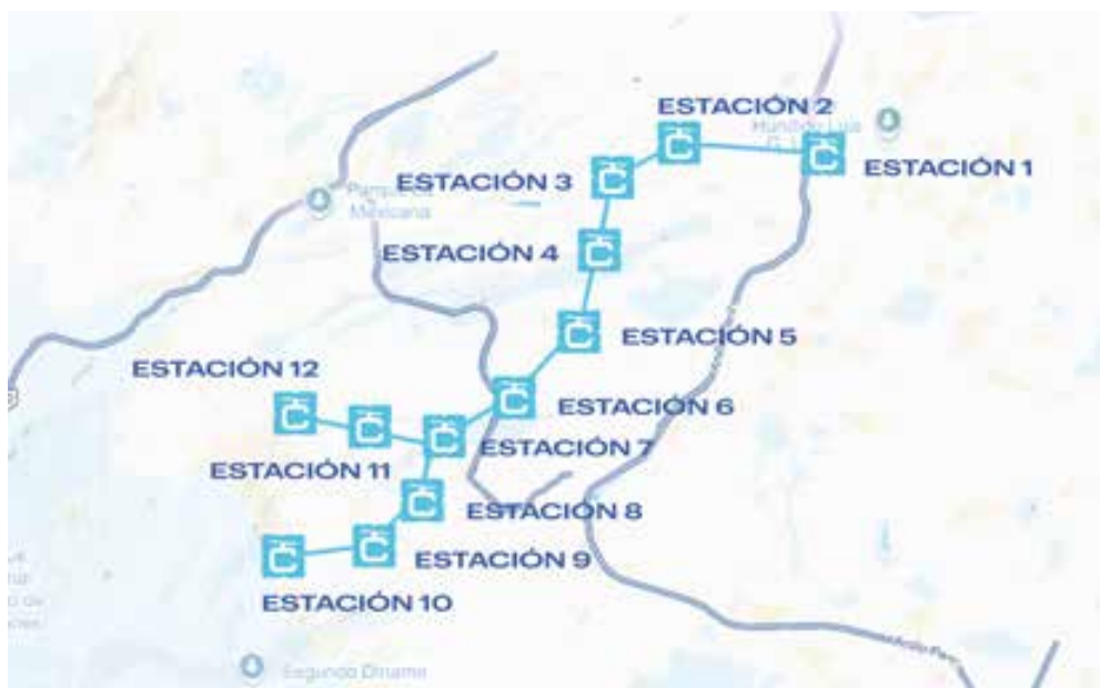
Die 15,2 Kilometer lange Seilbahnlinie umfasst 12 Stationen, 462 10-Personen-Kabinen und 114 Stützen. Die Anbindung der Metrostation Mixcoac (Linien 7 und 12) stärkt die vernetzte Mobilität im Westen von Mexiko-Stadt. Die Zeitersparnis beträgt mehr als 50 Prozent.
