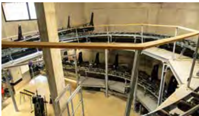
Innenansicht der Station: Kreiselförmiges Garagierungssystem für 30 Rodel.
