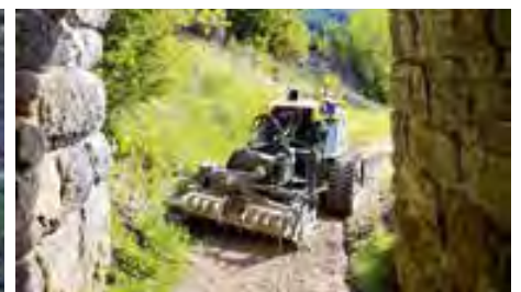
Der MAXpro Stonecrusher verteilt Material direkt auf dem Trail und folgt dabei der Weglinie.
