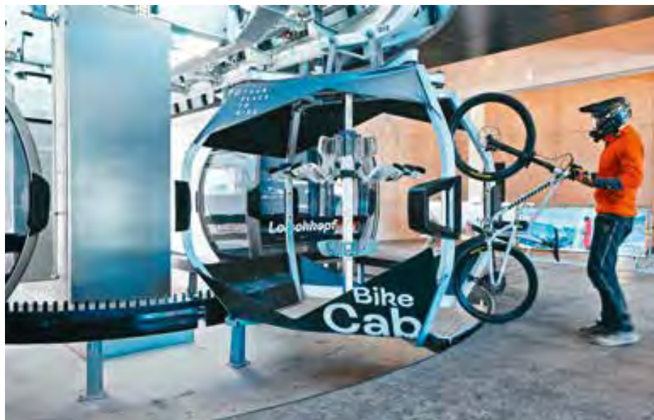
Die Gäste hängen ihre Räder selbstständig in die 20 Bike Cabs der Loischkopfbahn ein.
