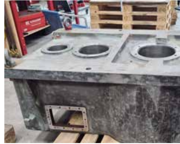
Das sandgestrahlte Getriebe wird von der Kissling AG mittels UT/MT (Ultraschall / Magnetpulverprüfung) auf Risse im Material untersucht.
