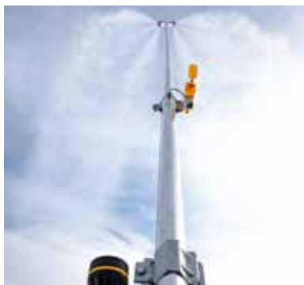
Herzstück der TL8 Double ist die Kombination aus zwei TL8-Köpfen und nur einem Ventilblock vom Typ Smart Distributor. © TechnoAlpin
