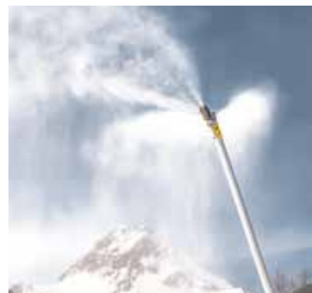
Die Installation erfolgt auf einem Standardlanzenrohr und benötigt lediglich ein Schachtventil.
