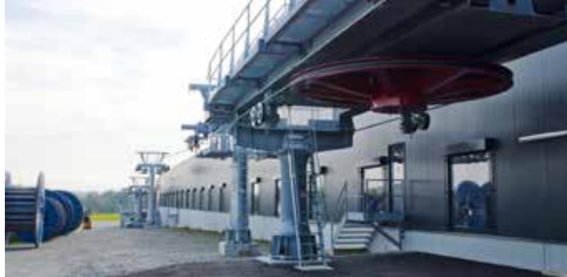
Mit der eigenen Testseilbahn werden die Innovationen an Seilen unter realen Bedingungen getestet. © Fatzer AG
