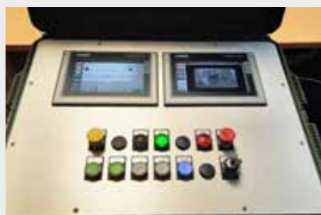
Die Seilbahn wird vom Bedienstand aus gesteuert (links). Zum Eis-Abfahren können jedoch auch Mitarbeiter der Planai-Hochwurzen-Bahnen über eine Bedienstelle im Außenbereich die Bahn rudimentär steuern (Mitte). Über einen Fernwartungskoffer hat auch die Kaserne in Salzburg Zugriff.
