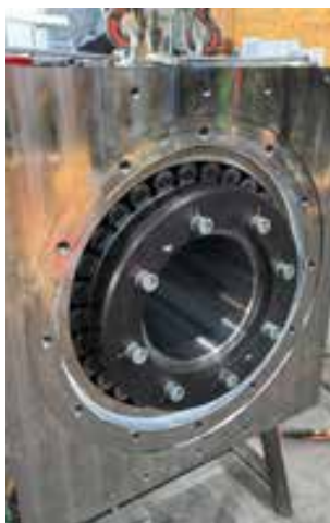
Neuer Lagerbock mit verstärkter Hohlachse.
