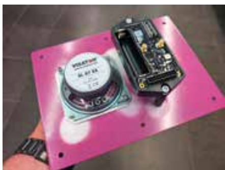
Rückseite SisLink-Platte am Bettmerhorn: Bei einer minimalen Nutzung (Audiotests/Notfalldurchsagen) ist das System wartungsfrei.
