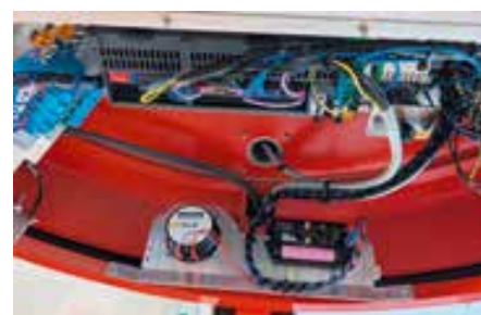
SisLink-Platte in der Drehgondel: Die Montage erfolgt in der Regel über ein Halblech in der Zwischendecke der Kabine.
