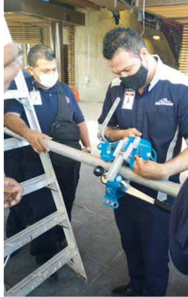
Das Seilfahrgerät SS1, welches weltweit inzwischen schon über 2.000-mal im Einsatz ist, ist dank der autonomen Bedienung ideal für den Einsatz bei urbanen Seilbahnen.
