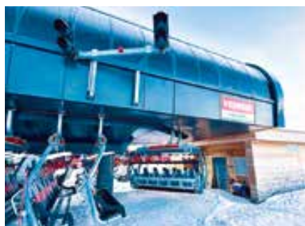
Ein Highlight ist das kompakte Stationsgaragierungssystem. © Télévrier SA
