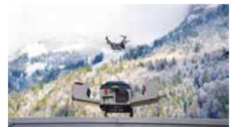
Nahe der Talstation wird die Drohne in einer Docking-Station geladen und beheizt. Von dort aus startet sie ihre Flüge. © SCARA captures
