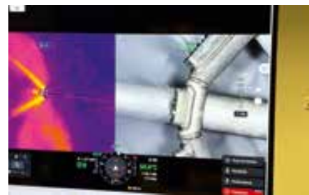
Verstopfte Düse mit 34x Zoom deutlich sichtbar © BÄCHLER
