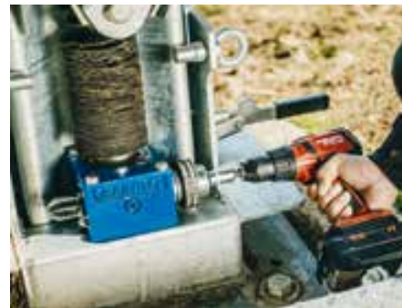
Zum Heben und Senken des E-TOWERS reicht ein Akkuschrauber.
