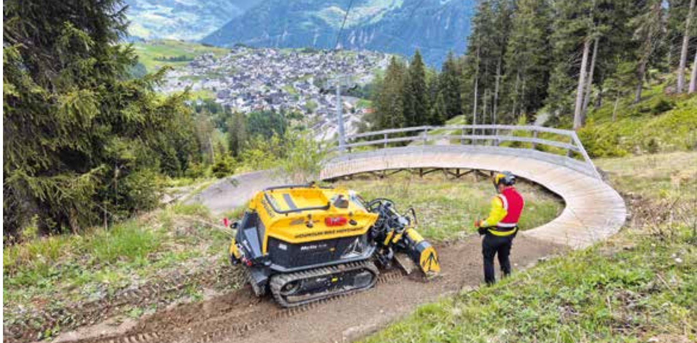
Der Moritz mit Trailfräse ist ein ferngesteuerter, kompakter Geräteträger mit Raupenfahrwerk – bewährt in allen Höhenlagen, vom Bikepark bis zur hochalpinen Wegpflege. © PFANZELT
