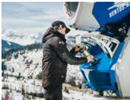
Der E-TOWER ist für die Wartung einfach absenkbar und von allen Seiten zugänglich.
