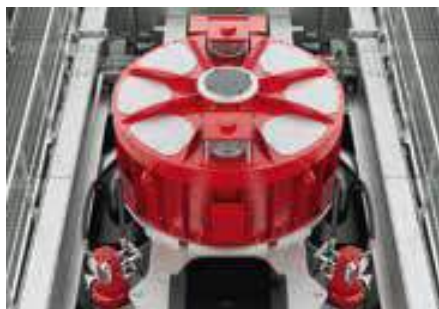
Das Antriebssystem LEITNER DirectDrive funktioniert ohne jegliches Getriebe.
